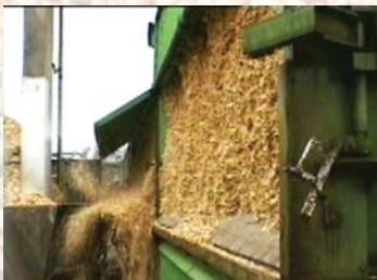
Produit tassé et gelé durant le transport Wood chips compacted and frozen
